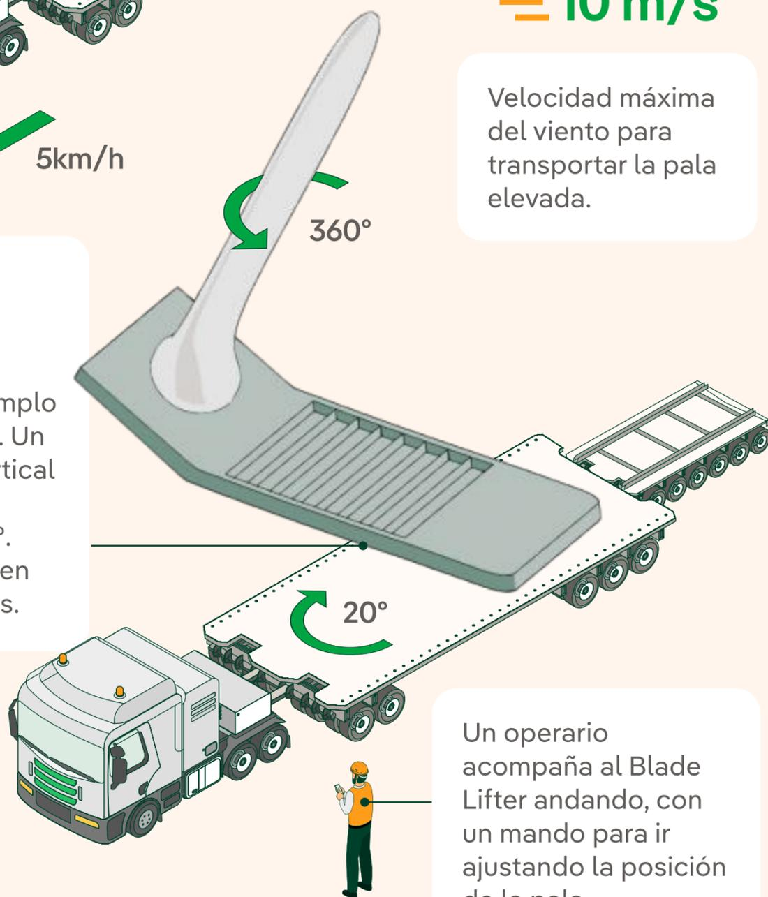
Un operario acompaña al Blade Lifter andando, con un mando para ir ajustando la posición de la pala.
