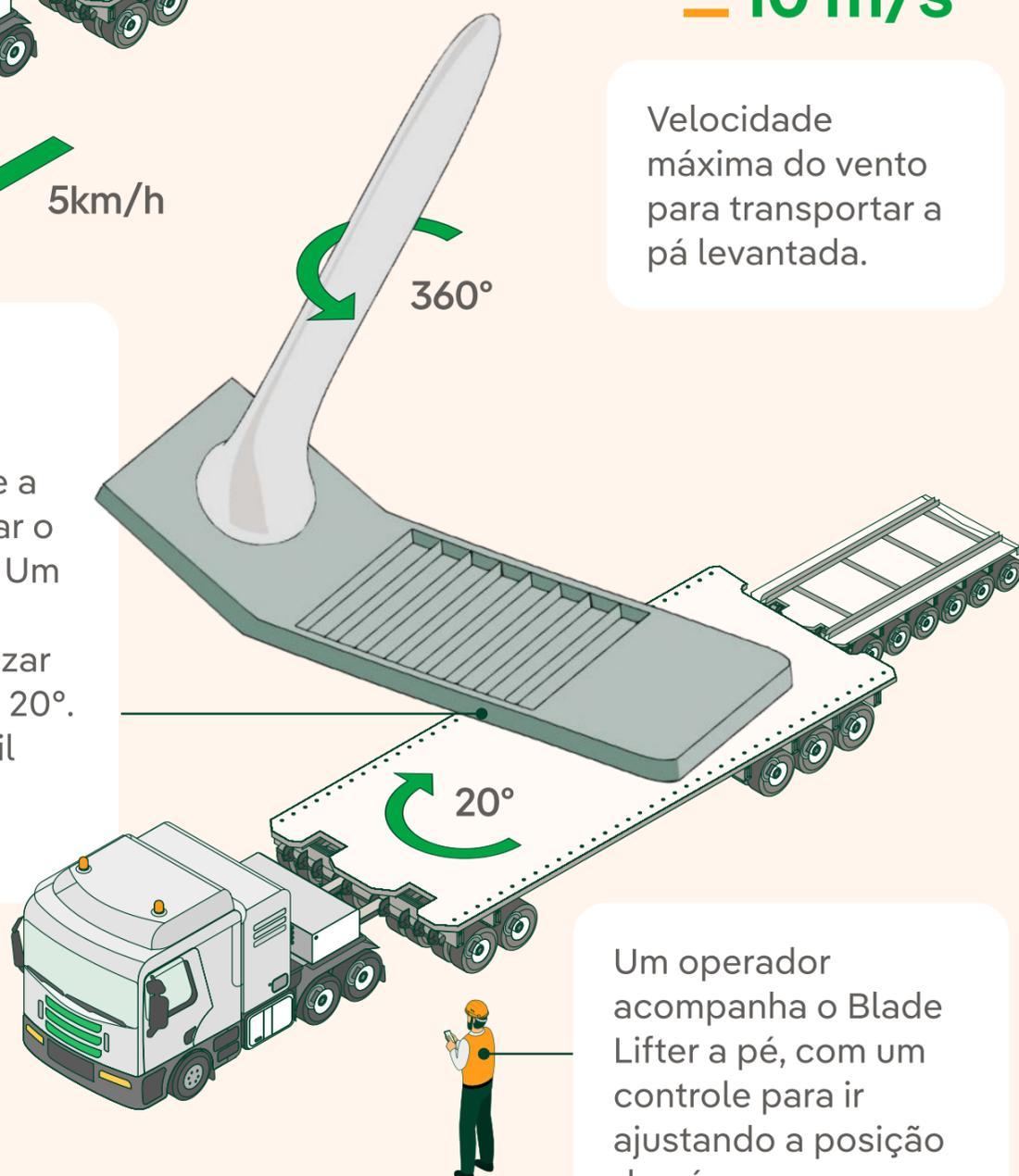
Um operador acompanha o Blade Lifter a pé, com um controle para ir ajustando a posição da pá.
