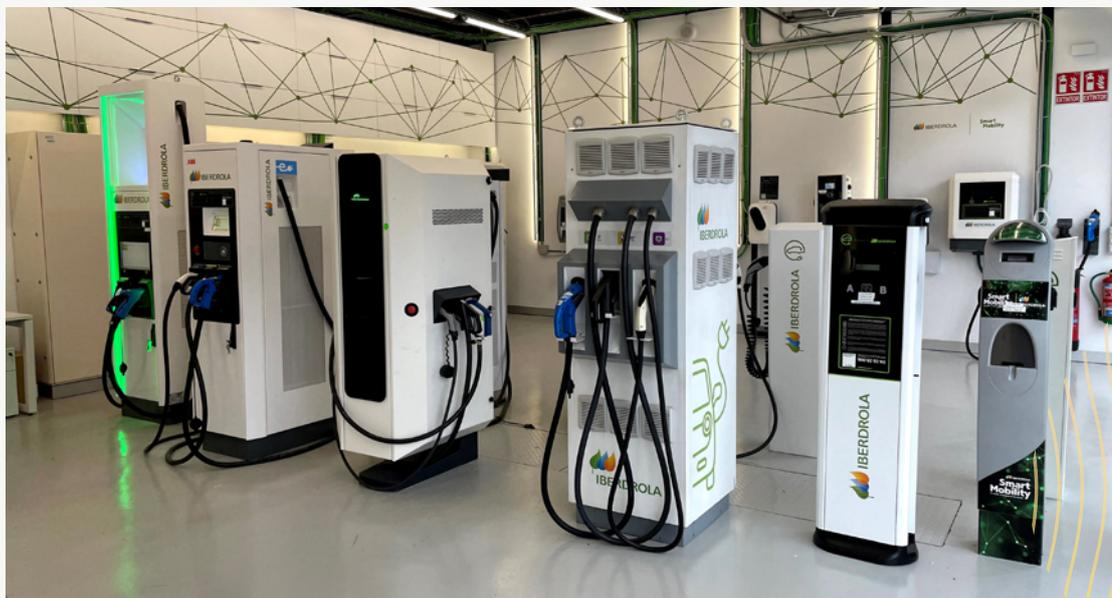
Nosso laboratório de mobilidade elétrica está localizado em Bilbao, equipado com as mais recentes tecnologias de recarga para veículos elétricos. O laboratório possui aproximadamente 30 pontos de carga (PDC) com diferentes potências, servindo assim como centro de testes para os fabricantes dos PDC e como apoio ao serviço de pós-venda pois pesquisa as incidências encontradas em equipamentos operacionais, replicando-os e oferecendo soluções remotas.
