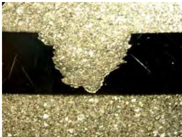
Corrosión en acero inox dúplex tipo 2205 (izquierda) y en acero inox austenítico AISI 316L (derecha)
