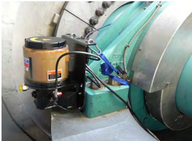
Sistema de autolubricación rodamientos del rotor
