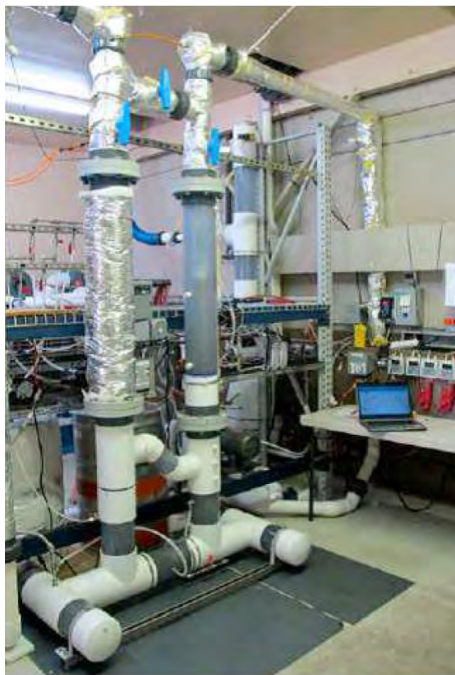
Proceso de control de macrofouling usando CO 2
