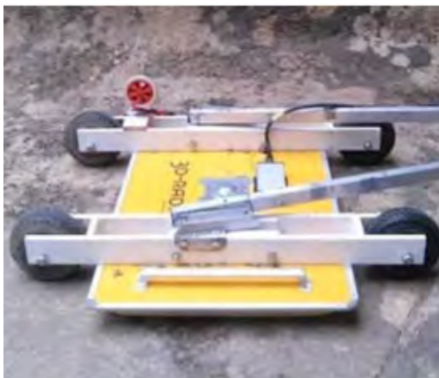
Antena de contacto de Geo-Radar tridimensional
