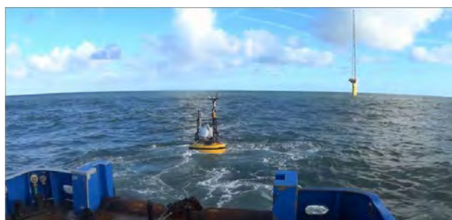
Lídar flotante (Fuente: web de ScottishPower)
