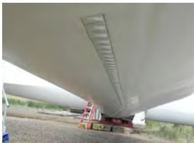
Generación de vórtices en palas de aerogeneradores
