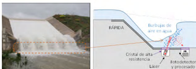
Ejemplo de aplicación de sensado óptico de burbujas de aire en una presa
