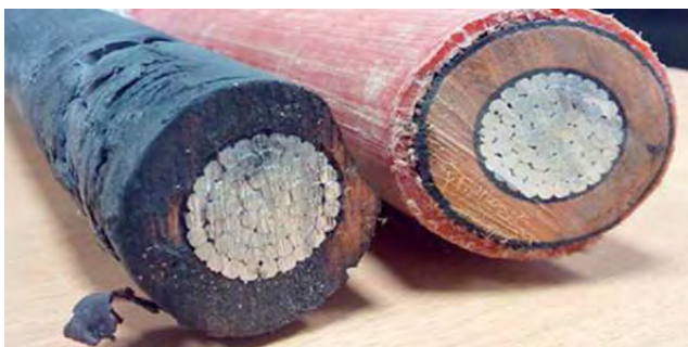
Corte transversal de cable con dos grados distintos de envejecimiento
