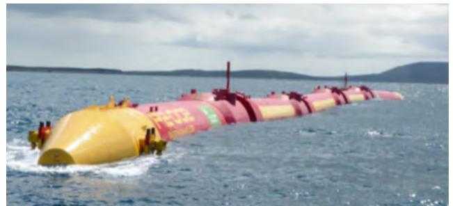
Dispositivo Pelamis P2 (fuente Web de ScottishPower Renewables)
