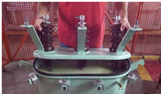
Transformador de aceite vegetal
