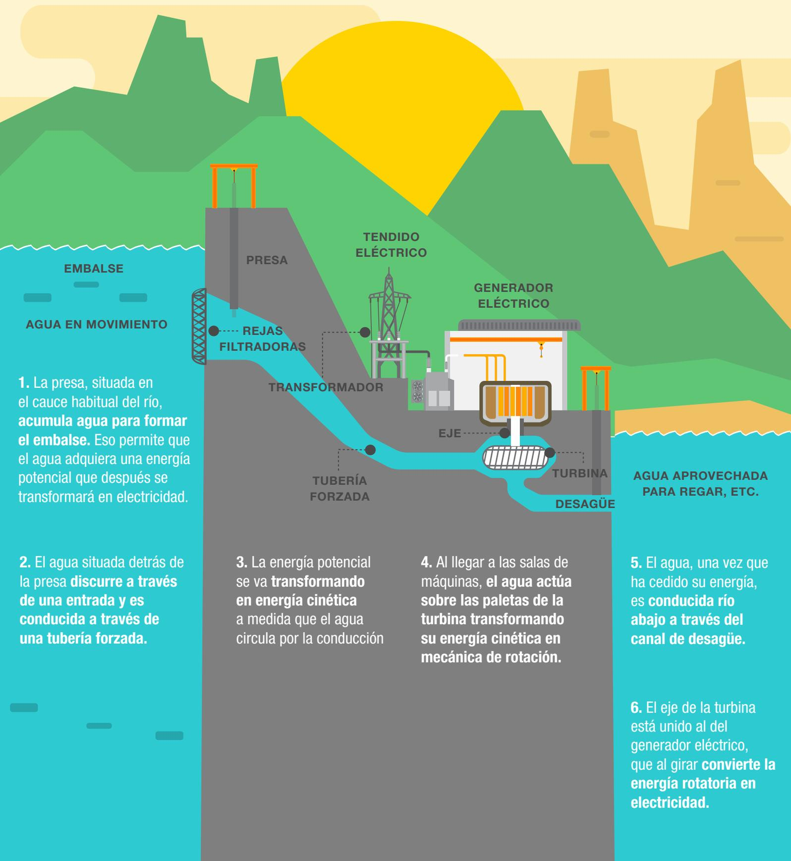
1. La presa, situada en el cauce habitual del río, **acumula agua para formar el embalse**. Eso permite que el agua adquiera una energía potencial que después se transformará en electricidad.
